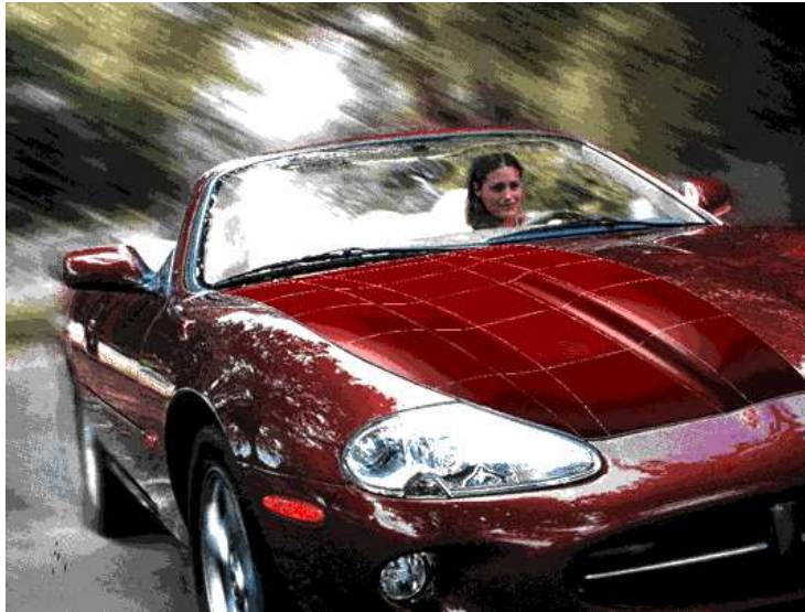
Abb. 204. Class A-Flächen im Exterieur, Jaguar XK8. Ein Teil der Fronthaube wurde absichtlich mit Flächenstrukturgrenzen dargestellt
