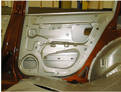
Abb. 206. Class B-Flächen, Aluminium-Gerippeteile des Audi A2
